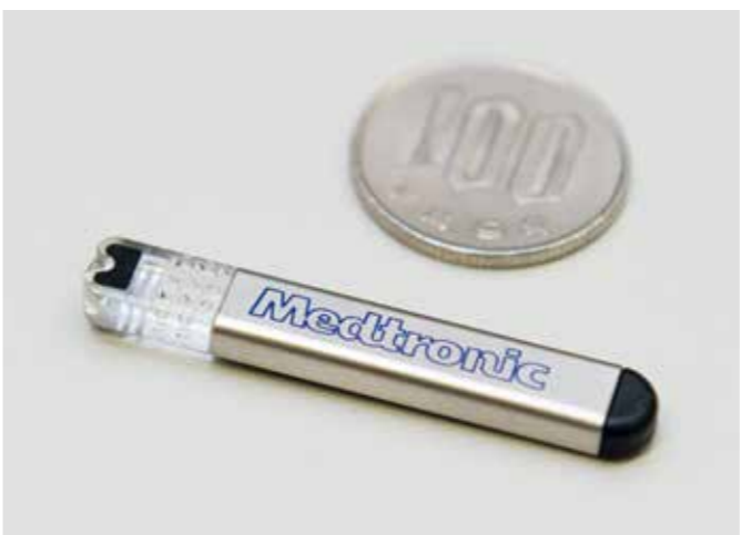
症状のない心房細動の発見に大きな効果を発揮する植え込み型心電計
