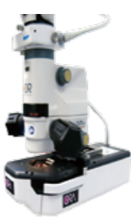
金沢医科大学病院が導入した新装置の一つ、術中波面収差解析装置。手術中に眼内レンズの度数計算や乱視軸などが測定できます
