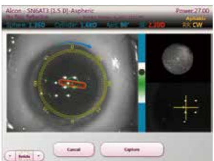
金沢医科大学病院が導入した新装置の一つ、術中波面収差解析装置。手術中に眼内レンズの度数計算や乱視軸などが測定できます
